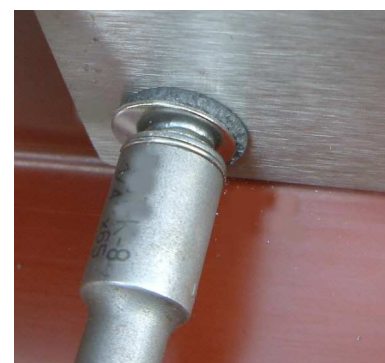
Lors du vissage, veillez à n'effectuer qu'une légère compression du joint; en présence de nombreuses pièces veuillez vous servir d'une butée de profondeur!
