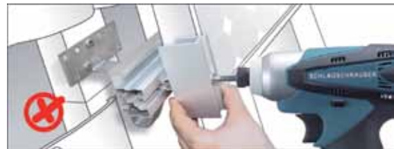
Ne pas utiliser de perceuse-visseuse à percussion !
