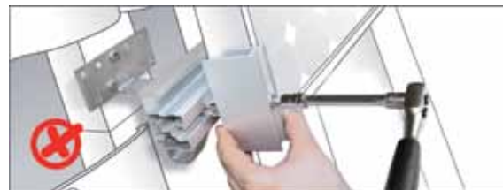
Ne pas utiliser de clé à cliquet !
